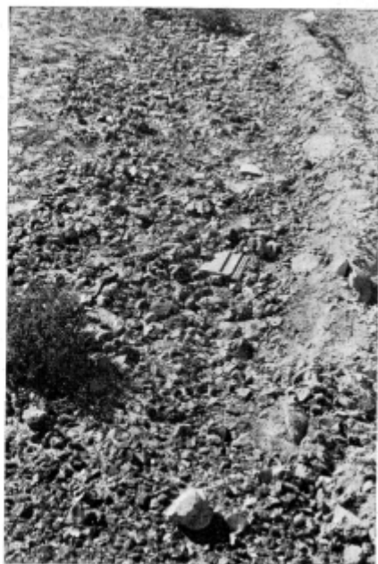
1. הסוללה בתחתית החלקה שבשבטה בתחילת הניסוי. ברצועת־השטח שמעל לסוללה לא חוסרו אבני־הכיסוי. פני־השטח משתפלים משמאל לימין (8 בפברואר 1955).
